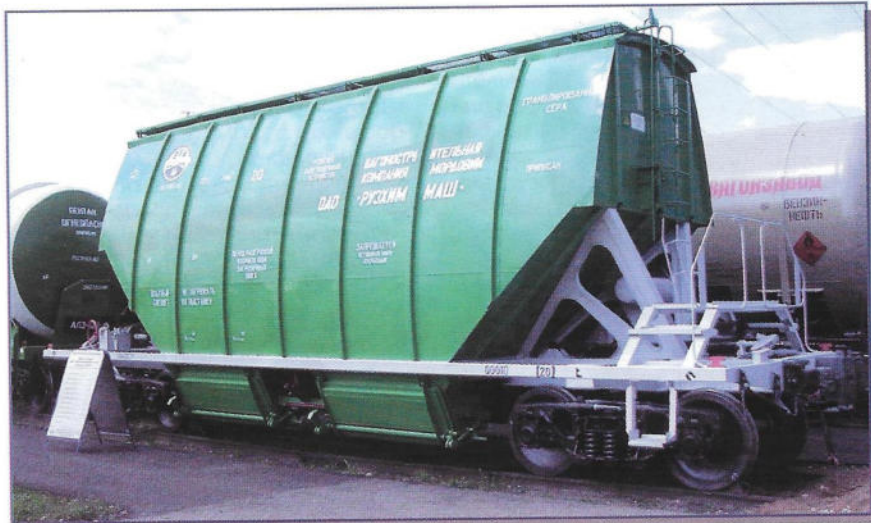
Вагон-хopper для перевозки гранулированной серы. Основные технические характеристики: масса тары 21,7 т, грузоподъемность 72 т, коэффициент тары 0,3, объем кузова 74 м 3
