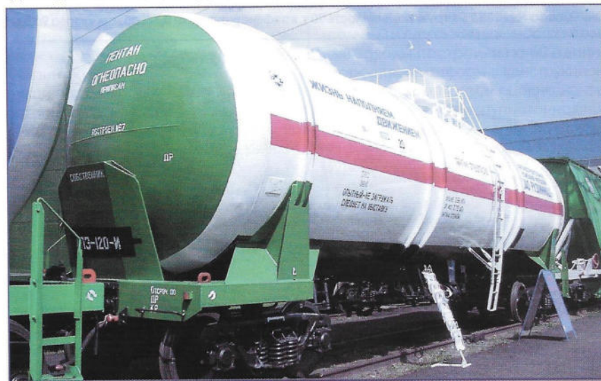
Цистерна для перевозки пентана. Основные технические характеристики: масса тары 28,6 т, грузоподъемность 55,1 т, коэффициент тары 0,52, объем котла 95,2 м 3
