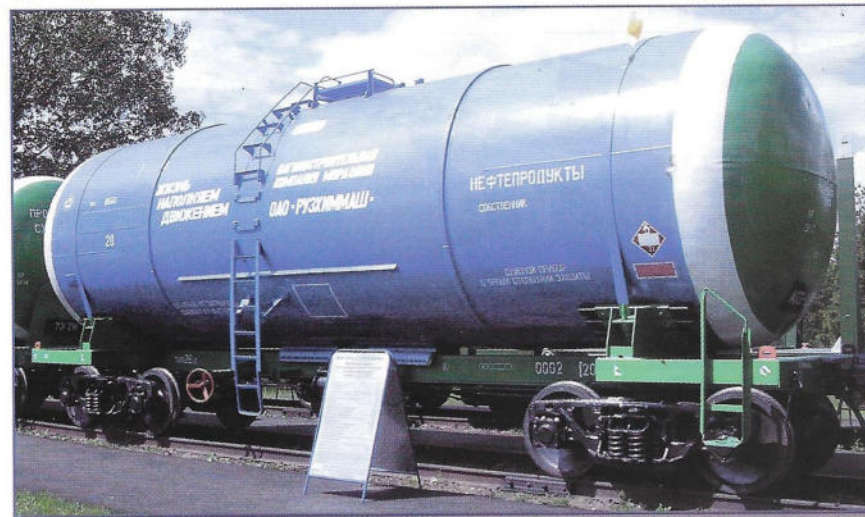
Цистерна для перевозки нефтепродуктов. Основные технические характеристики: масса тары 24,9 т, грузоподъемность 69,1 т, коэффициент тары 0,36, объем котла 85,6 м 3
