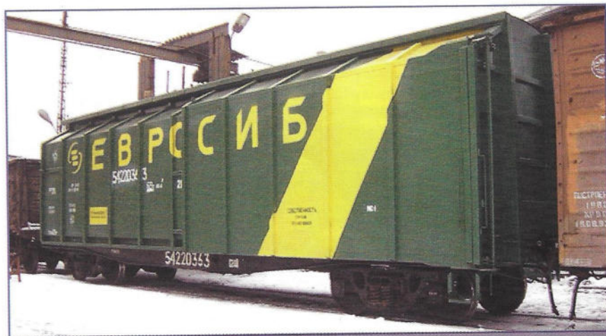
Крытый вагон для перевозки пакетированных грузов, требующих защиты от атмосферных осадков. Основные технические характеристики: масса тары 25 т, грузоподъемность 68 т, коэффициент тары 0,37, объем кузова 110 м 3
