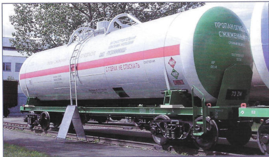
Цистерна для перевозки пропана. Основные технические характеристики: масса тары 40 т, грузоподъемность 53,5 т, коэффициент тары 0,75, объем котла 96,6 м 3
