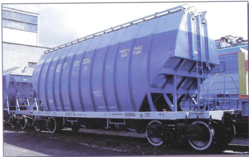
Вагон-хopper для перевозки минеральных удобрений. Основные технические характеристики: масса тары 23,75 т, грузоподъемность 70 т, коэффициент тары 0,34, объем кузова 96,5 м 3
