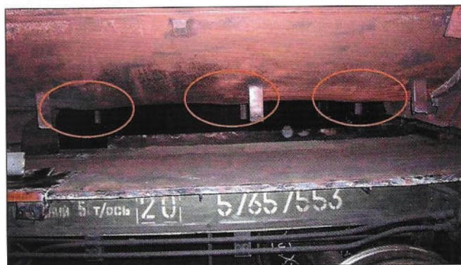
Рис. 2. Остаточная деформация броневых листов котла вагонов-цистерн модели 15-1532 в зонах термического влияния нагревательных элементов
