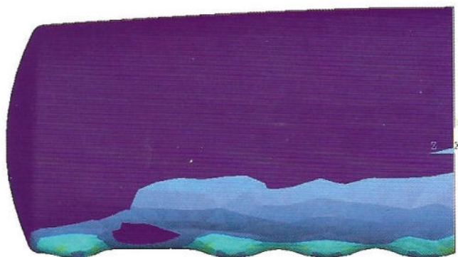
Рис. 7. Локальные прогибы в зонах термического влияния нагревательных элементов вагона-цистерны модели 15-1532
