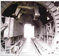
Рис. 2. Общий вид и схема вагоноопрокидывателя роторного типа
