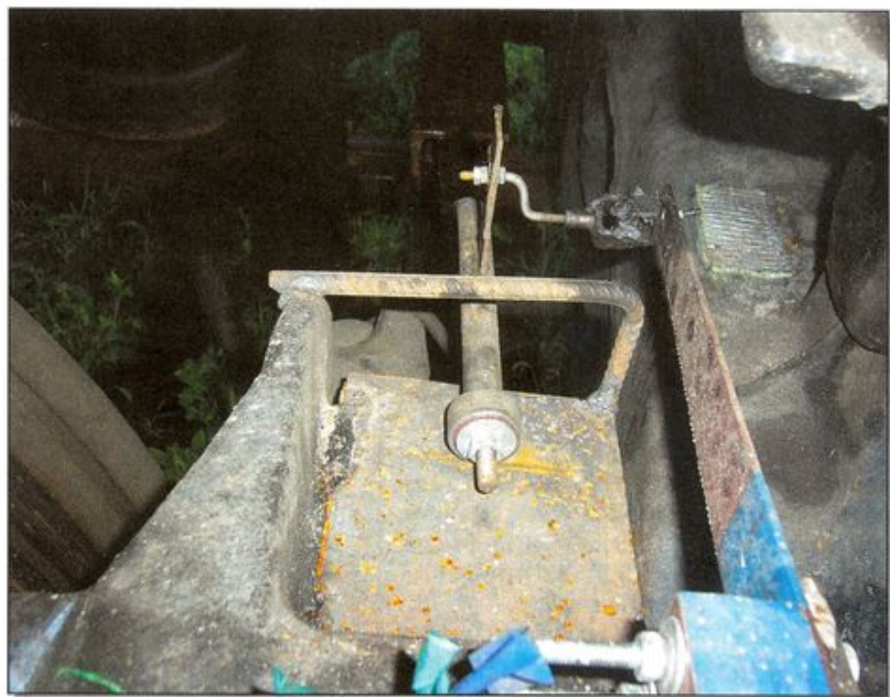
Рис. 6. Схема крепления прогибомера для регистрации взаимного забегания боковых рам тележки: 1 — прогибомер; 2, 4 — боковая рама; 3 — балка
