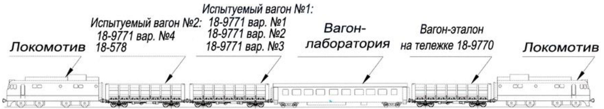
Рис. 1. Схема опытного состава для проведения ходовых испытаний
