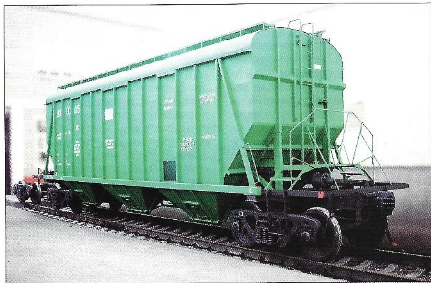
Рис. 6. Вагоны на тележках модели 18-9810: универсальный полувагон с разгрузочными люками модели 12-9761-02 (вверху) и вагон-хopper для минеральных удобрений модели 19-9835-01
