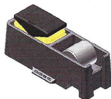
Рис. 3. Упруго-катковый скользящий ISB-12C конструкции компании «A.Stucki» (США)
