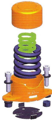
Рис. 1. Пружинный скользящий «Preload Plus 4500» компании «Amsted Rail Company, Inc» (США) тележек 18-9836 (ЗАО «Промтрактор-Вагон»)
