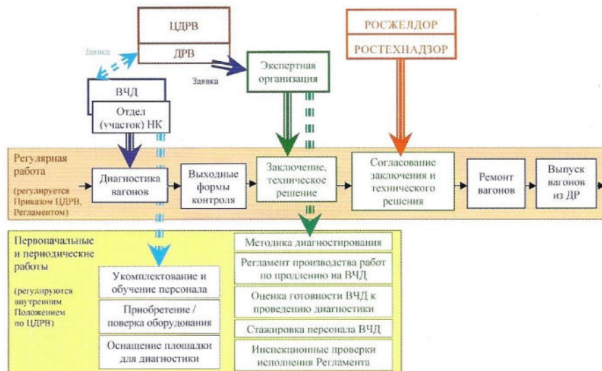
Рис. 6. Схема взаимодействия ЦДРВ и организации-исполнителя по продлению срока службы полувагонов при деповском ремонте в вагоноремонтном депо
