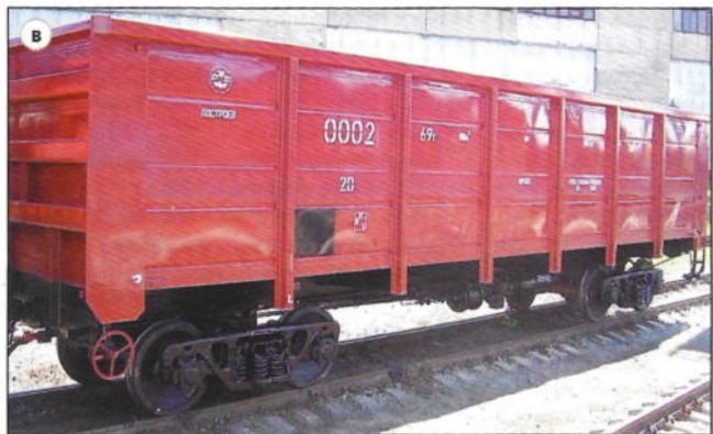
Рис. 2. Общие виды разработанных кузовов полувагонов: а — Канашского ВРЗ; б — Рославльского ВРЗ в исполнении с разгрузочными люками; в — Рославльского ВРЗ в исполнении с глухим дном
