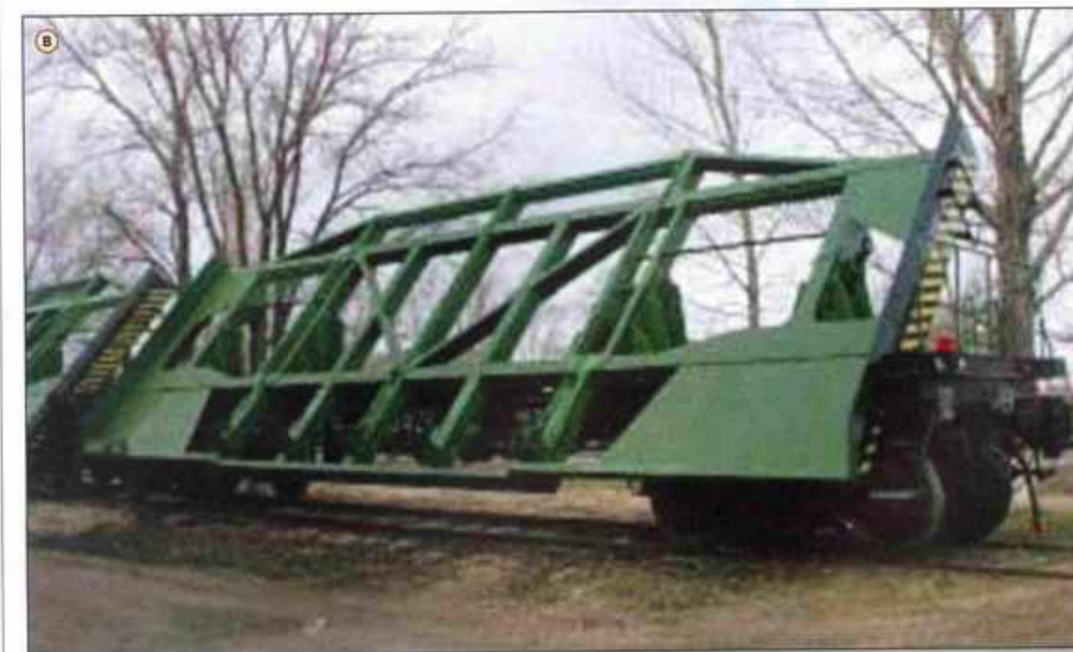
Рис. 4. Вагоны для перевозки широкоформатного листового проката: а — вагон Sips-u 725 компании «Greenbrier»; б — вагон модели 13-4107, «Днепровагонмаш»; в — вагон модели 13-9874, Завод металлоконструкций, г. Энгельс
