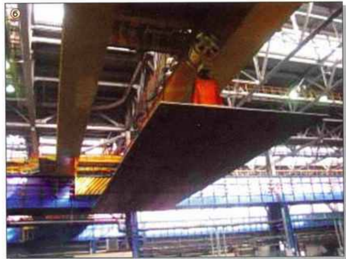
Рис. 2. Погрузка широкоформатного листа с помощью магнитного грузоподъемного устройства: а — магнитное грузоподъемное устройство; б — подъем широкоформатного листа магнитным устройством
