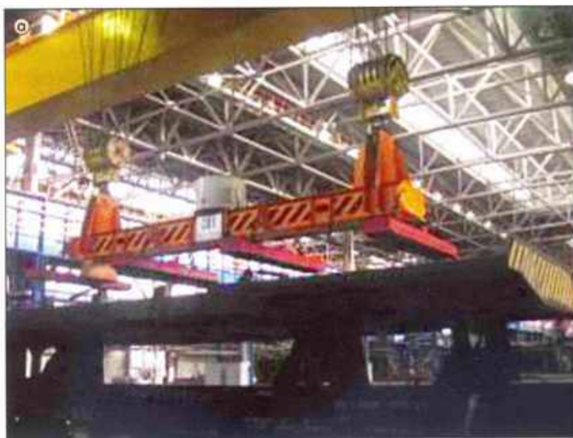
Рис. 2. Погрузка широкоформатного листа с помощью магнитного грузоподъемного устройства: а — магнитное грузоподъемное устройство; б — подъем широкоформатного листа магнитным устройством
